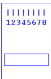
Slika 1: RJ45 utičnica prikazana suprotno od strane na kojoj se nalazi jezičak (spring clip) - numeracija pinova
